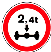
C5 – Trânsito proibido a veículos de peso por eixo superior a ... toneladas
