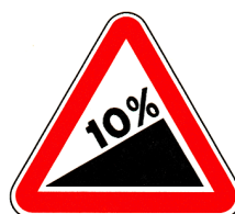
A3b – Subida de inclinação acentuada
