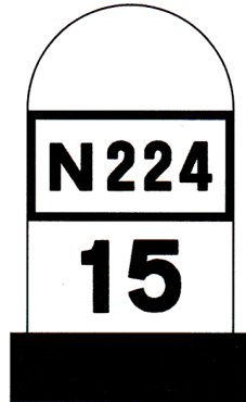
02d – Demarcação quilométrica da via – restantes estradas
