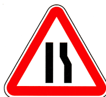
A4c – Passagem estreita
