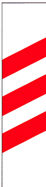
19a – Aproximação de passagem de nível
