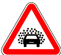
A13 – Visibilidade insuficiente
