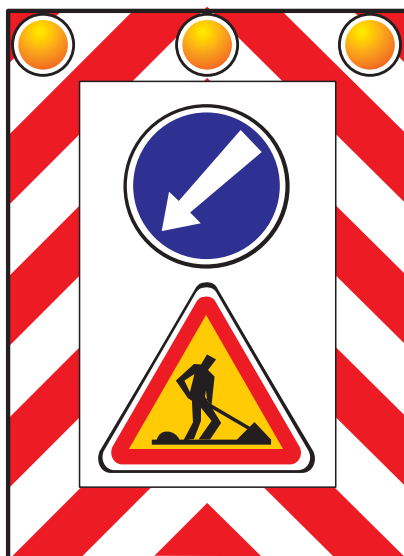
ET 12 — Atrilado de balizamento
