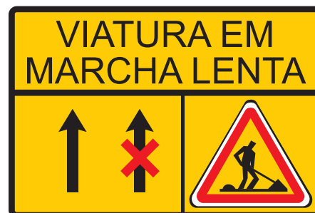
TC 9 — Painel indicativo de circulação de viatura em marcha lenta (2 vias) Dim = 2,33 x 2,10 m
