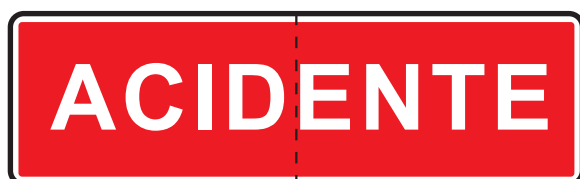
TV 5 — Painel de sinalização de acidente Dim. = 1,16x0,30 m
