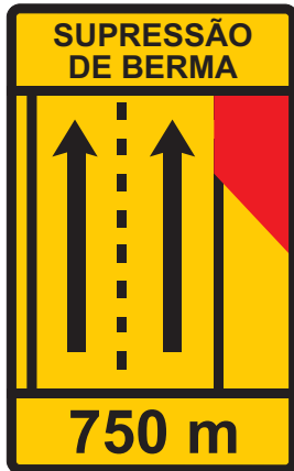
TC 7 — Painel indicativo de supressão de berma (2 vias) Dim = 1,40 x 2,90 m
